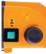
Bouton de marche vert et interrupteur à clé
